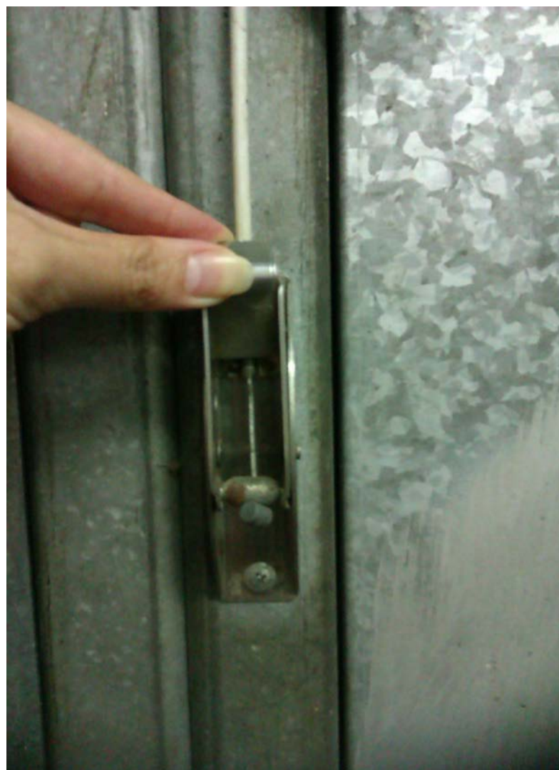
3.手動離合器開關(推拉式)停電時往手動定位(示範定位)
