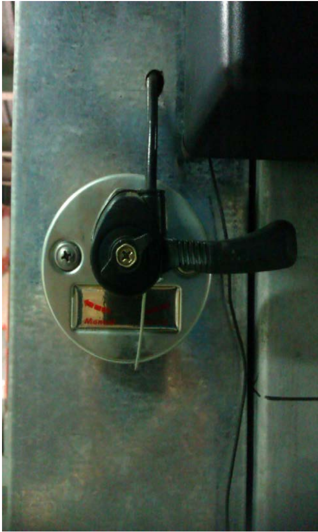
2.手動離合器開關(旋扭式)停電時往左手動定位（示範往左）
