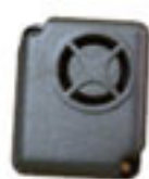
SV-612 蜂鳴器 工作電壓: DC6-14V 消耗電流: 110mA 警報音量: 110dB 外型尺寸: 47(L)x40(w)x22(D)mm
