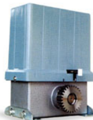
排齒式 馬力：1/2P - 2P 輸出軸：8Px28TB 輸出轉速：33
